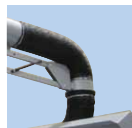
Slange Slangen er standard af typen S10 i ø200mm-udgave.
